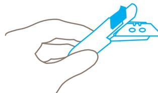
Afin de garantir le bon fonctionnement de la protection de la lame, il est nécessaire d'ôter régulièrement les restes de matières éventuellement déposées à l'intérieur du couteau.
