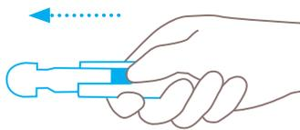
En prenant appui sur le curseur, pousser l'insert en plastique hors du manche. Ne pas simultanément tirer sur l'insert et maintenir le curseur. Retourner ou changer la lame. Bien repositionner la lame nouvelle ou retourner dans ses ergots.
